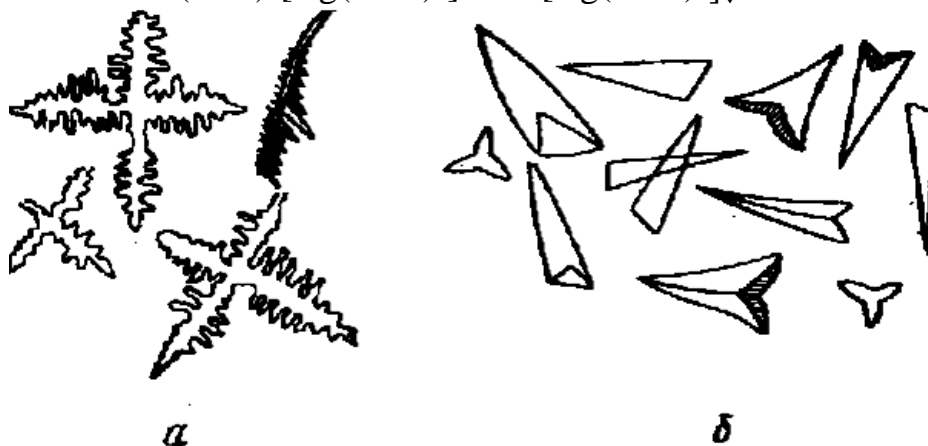
Рис. 5. Кристаллы Zn[Hg(SCN)_4] , полученные в обычных условиях (а) и в присутствии минеральных кислот (б) (или в очень разбавленных растворах)
