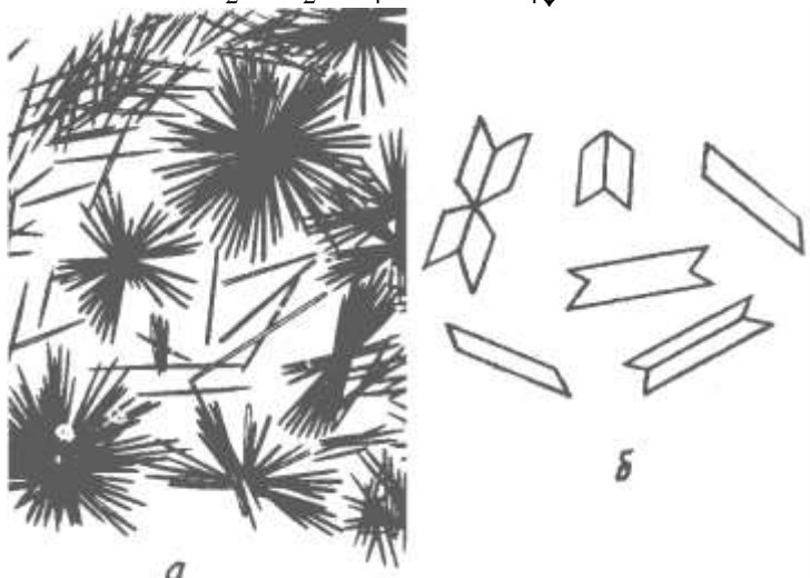
Рис. 4. Кристаллы \text{CaSO}_4 \cdot 2\text{H}_2\text{O} , образующиеся в разбавленных (а) и концентрированных (б) растворах кислот
